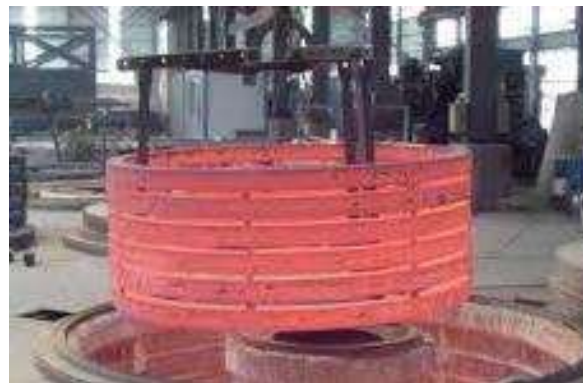
Figura 4 - Dispositivo di movimentazione per anelli
