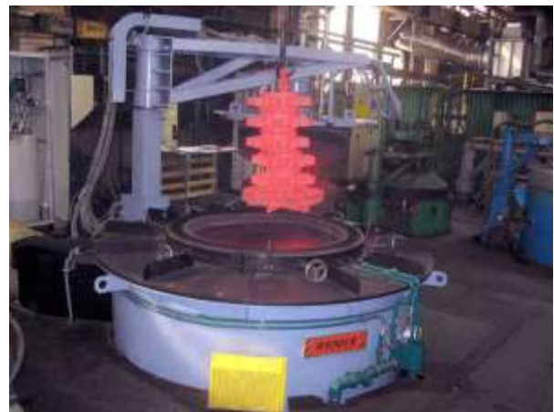
Figura 3 - Estrazione dell'attrezzo con la carica da un forno a pozzo
